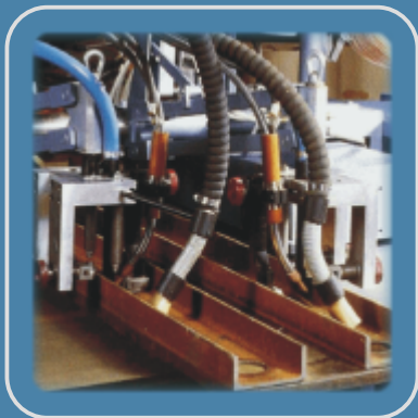
Urządzenie do spawania profilu skrzynkowych w poziomie (agregat dwupalnikowy)
