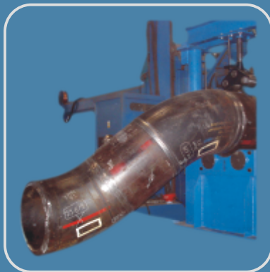
Obrotnik rolkowy do obracania elementów o złożonych kształtach
