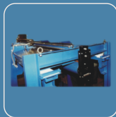
Urządzenie do spawania rur, walczków oraz arkuszy blachy
